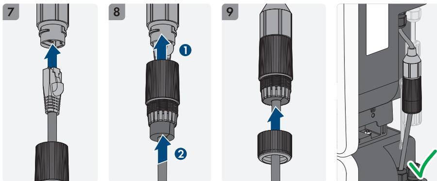
**en** Connecting the DC cables to the inverter **de** DC-Kabel zum Wechselrichter anschließen
