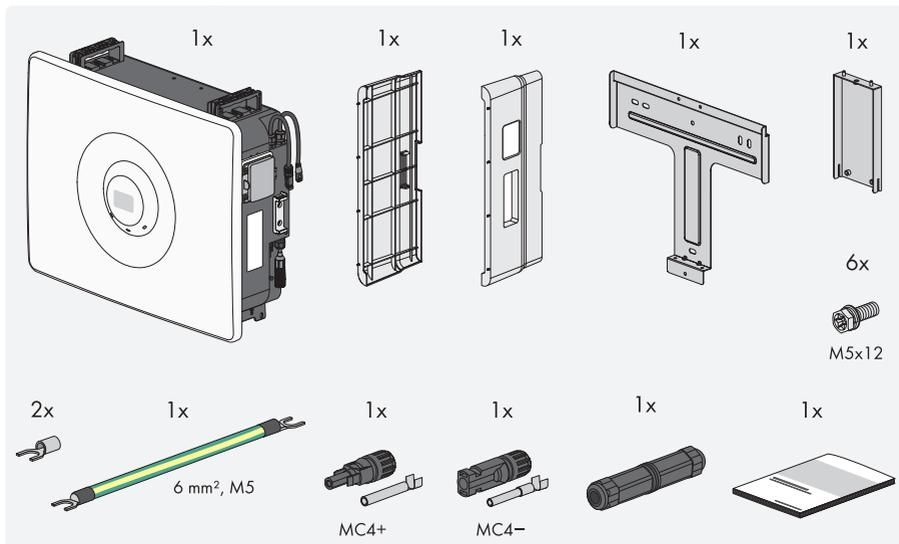
**en** Scope of delivery of base **de** Lieferumfang Sockel **da** Leveringsomfang for sokkel **es** Contenido de la entrega con pedestal **fr** Contenu de la livraison socle **hu** Alízat szállítási terjedelme **it** Contenuto della fornitura zoccolo **nl** Leveringsomvang sokkel **pl** Zakres dostawy podstawy **pt** Volume de fornecimento da base **ro** Setul de livrare al soclului **sv** Leveransomfattning av sockel
