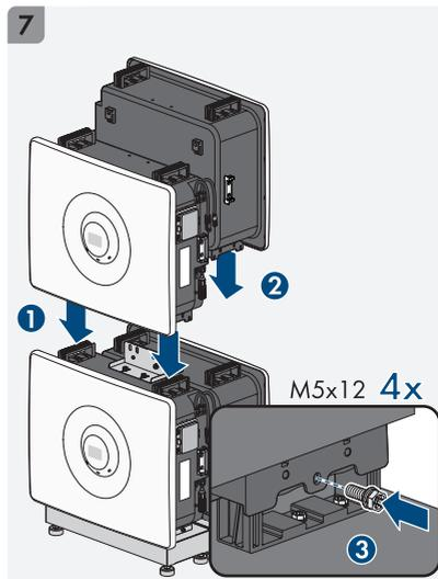
**en** Grounding the Battery **de** Batterie erden **da** Jording af batteri **es** Puesta a tierra de la batería **fr** Mise à la terre de la batterie **hu** Akkumulátor testelése **it** Messa a terra della batteria **nl** Batterij aarden **pl** Uziemienie akumulatora **pt** Ligar a bateria à terra **ro** Împământarea bateriei **sv** Jordning av batteri
